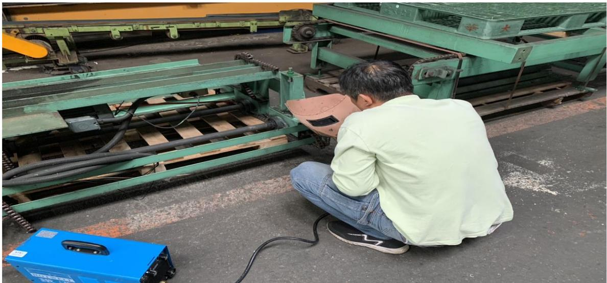
職務再設計方案-利用手提式氬焊機替代傳統焊接機。
